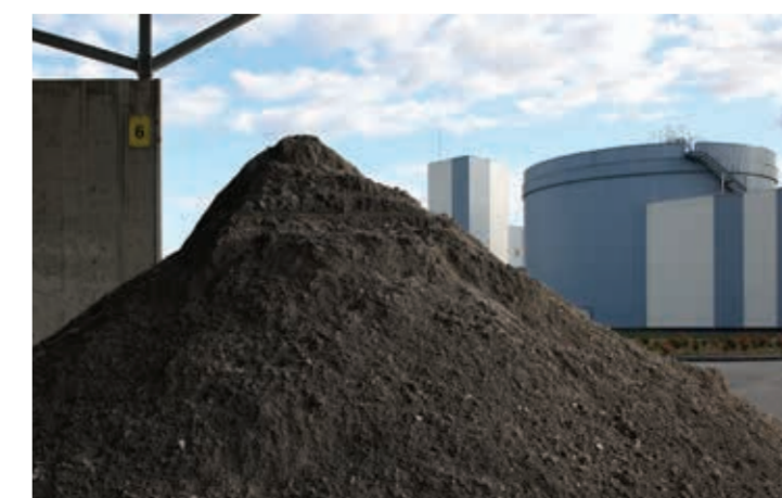
Mâchefers en phase de maturation à l'UVETD de Chambéry et en attente d'un projet de travaux publics.
