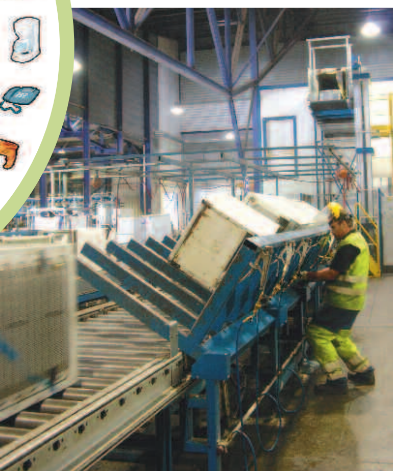
Extraction du fréon contenu dans le réfrigérateur
